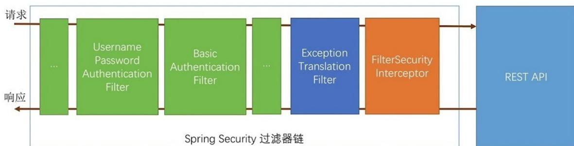
图中只展示了核心过滤器，其它的非核心过滤器并没有在图中展示。
